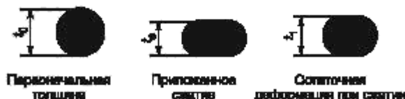
Рисунок 6 — Остаточная деформация при сжатии уплотнительного кольца
